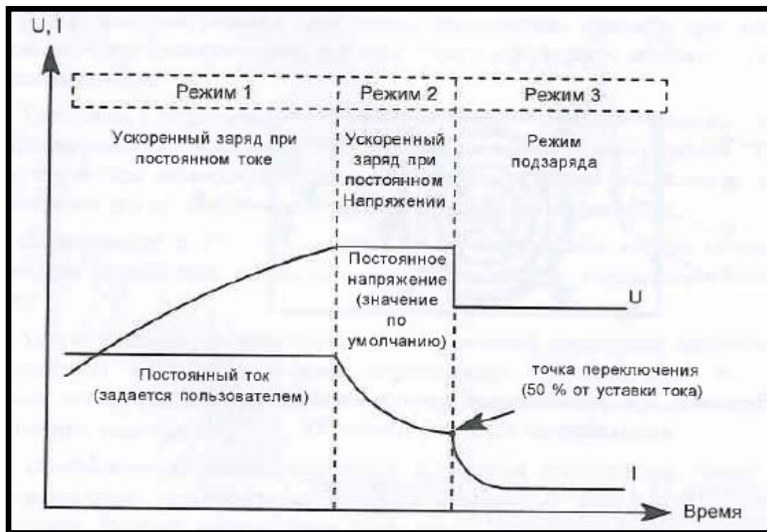
Рисунок 1 – График изменения тока и напряжения при заряде батареи
